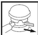
4. Retirez la languette de sécurité sous le dôme de la pompe (Figure 2).
