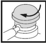
5. Tournez le dôme sur le dessus de la cannette jusqu'à ce que la fente semi-circulaire soit aligné avec l'embout de pulvérisation (Figure 3). La cannette est maintenant prête à être utilisée.
